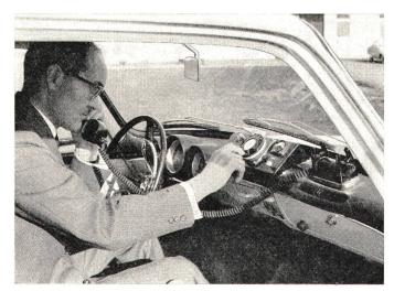
Fig. 6 Im Fahrzeug eingebauter Telefonapparat
