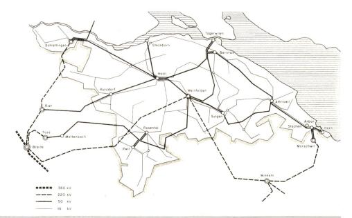
Fig. 2 Versorgungsstruktur des Kantons Thurgau mit elektrischer Energie (ohne Anschlussleitungen und lokale
