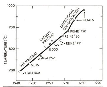
Fig. 2 Temperatur der Schaufeln in Gasturbinen und Jet-Triebwerken
