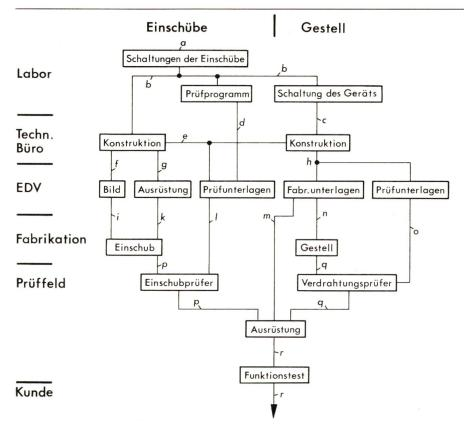
Fig. 1 Schema der Entwicklung eines digitalen elektronischen Gerätes
