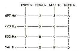
Fig. 3 Zuordnung der 16 Tasten zu den Frequenzen der Zeilen und Spalten
