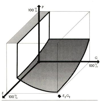
Fig. 1 Probabilité tolérable P d'apparition d'une panne en fonction de son étendue E et de sa gravité G
