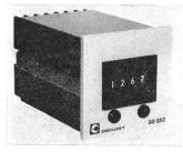
was ihm eine Genauigkeit in der Grössenordnung 10-2 s verleiht. 2 Leuchtzeichen signalisieren den Ablauf der Zeitverzögerung und den Schaltzustand des Ausgangs-Umschaltrelais. Lieferbare Ausführungen: Verzögerungszeit 99,99 s einstellbar in Stufen von 0,01 s oder 999,9 s in Stufen von 0,1 s; Funktionsarten: wahlweise Ablauf eines einzigen Zyklus oder automatische Wiederholung der Schaltzyklen.
