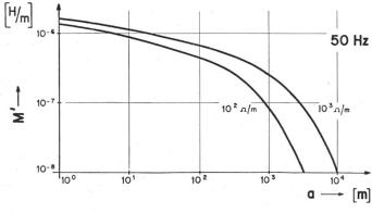
Fig. 4b Beziehung zwischen der Gegeninduktivität beider Stromkreise  $M^\prime$  und dem mittleren Abstand a
