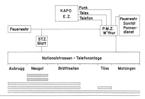
Fig. 1 Überblick über die Elektroanlagen der N1 zwischen der Stadtgrenze Zürich und der Bedienungsgrenze ZH/SG
