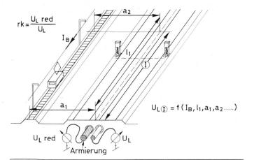
Fig. 3 Beeinflussungsprinzip der Kabel durch Betriebsströme von Bahnen
