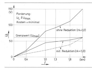
Fig. 5 Prinzip der Bestimmung der optimalen Kabelarmierung
