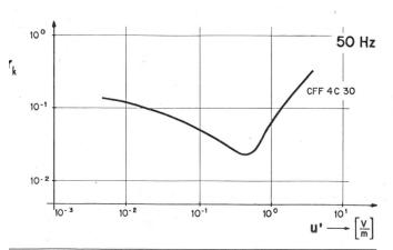
Fig. 4a Reduktionsfaktor  $r_k$  in Abhängigkeit des Spannungsbelags u'
