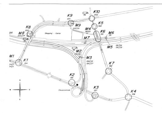
Fig. 2 Verkehrsregelungssystem im Bereich des Verkehrsdreiecks Wallisellen der N1
