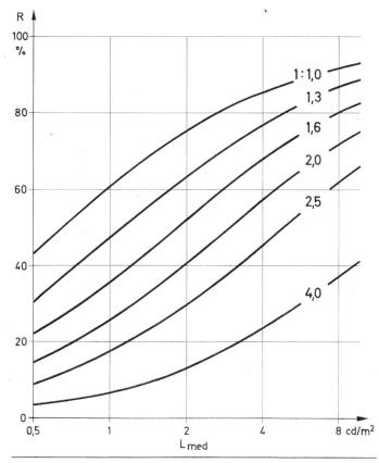
Fig. 1 Die Reaktionsleistung R, aufgetragen über der mittleren Leuchtdichte  $L_{\rm med}$  der Fahrbahn. Parameter ist die Längsgleichmässigkeit der Fahrbahnleuchtdichte. Photometrischer Kontrast der Sehobiekte 30 %, Grösse der Sehobiekte 8'.
