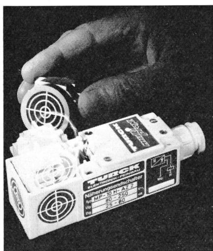
chanischer Kontakt mit zwei Schraubanschlüssen in den Leitungszug eingeführt werden. Sie setzen die berührungslose Annäherung von Metallen durch induktive Abtastung in ein Schaltignal hoher Leistung um. Sie arbeiten vollelektronisch ohne mechanisch bewegte Teile. Dies bedeutet: kein Kontaktabbrand, kein verklemmter Rollenhebel, beliebig viele Schaltspiele bei 80-VA-Dauerleistung (Comat AG, Worb).
