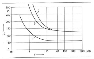
Fig. 3 Impédance caractéristique  $Z_c$  en fonction de la fréquence f
