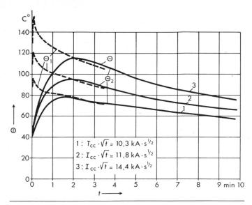
Fig. 7 Variation de la température Θ dès la fin du court-circuit pour le câble de garde avec paire coaxiale, câble nº 1 (Aldrey/Alumoweld: 100/50 mm²)
