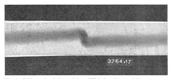
Fig. 8 Déformation de la cordelette HF de la paire coaxiale après essais de court-circuit de l'échantillon nº 3 (tableau IV), photographie prise par transparence  $I_{cc} = 12 \text{ kA}, t = 1,06 \text{ s}$
