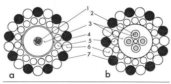
Fig. 1 Coupes de câbles de garde avec conducteurs de télécommunication incorporés a) avec paire coaxiale, b) avec quarte
