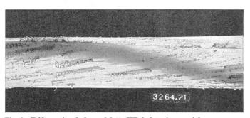
Fig. 9 Déformation de la cordelette HF de la paire coaxiale après essais de court-circuit de l'échantillon  $n^0$  4 (tableau IV), photographie prise par transparence  $I_{cc}=12.5~{\rm kA},~t=1.85~{\rm s}$
