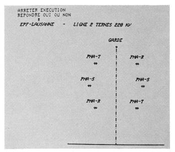
Fig. 7 Profil de ligne triphasée 2 ternes 220 kV
