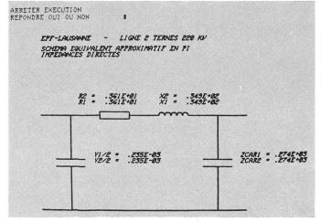
Fig. 11 Schéma équivalent en  $\pi$
