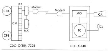
Fig. 4 Configuration du système informatique
