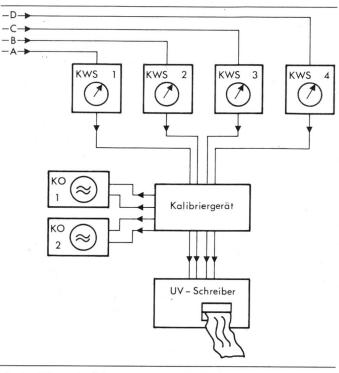
Fig. 5 Schema der Messanlage
