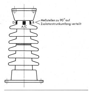
Fig. 3 Anordnung der Dehnmeßstreifen am Isolator
