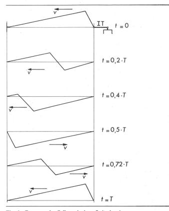
Fig. 6 Bewegung des Seils nach einem Leiterbruch  $\nu$  Wellengeschwindigkeit  $T=2\ l/\nu$  Laufzeit
