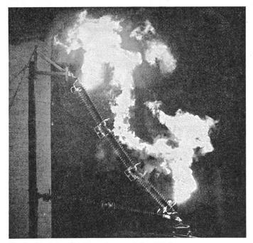
Fig. 2 Hochstromlichtbogen kurz nach dem Zünden
