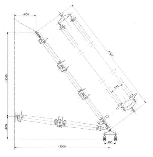
Fig. 3 380-kV-Isoliertraverse mit den aus Versuchen ermittelten optimalen Lichtbogen-Schutzarmaturen
