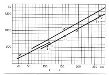
Stosshaltespannung (positiv) von Isolatorenketten, Isoliertraversen (IT) und V-Ketten in Funktion der Schlagweite L Die Kurven (a) einteilige Ketten und (b) mehrteilige Ketten sind der CEI-Publ. 433 (1973) entnommen.
