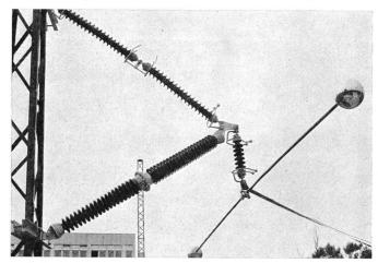
Versuchsausführung einer Isoliertraverse mit Pendelstütze für 245 kV; oben Zugkette, unten Druckstrebe
