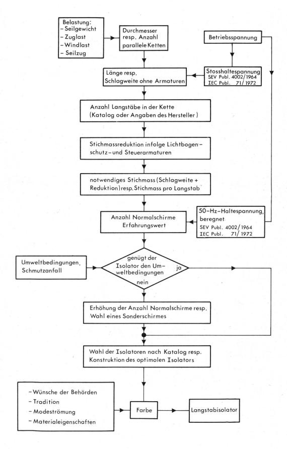
Fig. 1 Blockschema zur Bestimmung optimaler Langstabisolatoren
