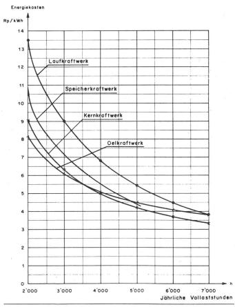
Fig. 3 Energiegestehungskosten verschiedener Kraftwerkstypen in Abhängigkeit von der Vollastbenutzungsdauer (berechnet anhand konkreter Anlagen und umgerechnet auf die Preisbasis von 1973)
