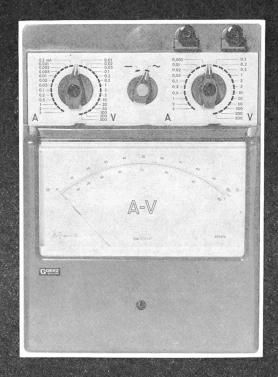
Drehspulmessgeräte für V, A Dreheisenmessgeräte für V, A
