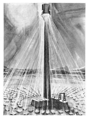
duzieren. Der Kern der Untersuchung besteht aus einem oben auf dem über 100 m hohen Turm angebrachten Dampfgenerator. Durch die am Fusse des Turmes verteilten Spiegelgruppen – Heliostaten genannt – werden die Sonnenstrahlen auf den Dampfgenerator gebündelt. Der Dampf wird dann unter Druck einer gewöhnlichen Dampfturbine zugeführt. Die Hitze kann auch zur späteren Verwendung gespeichert werden.
