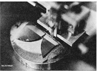
werden drei Spitzen aus Wolframkarbid mit einem Spitzenradius von 2,5  $\mu m$  vorsichtig in die polierte Siliziumoberfläche hineingesenkt, zwei der Spitzen (z. B. die rechte und die mittlere) an einen Stromkreis angeschlossen und zwischen der linken und mittleren Spitze eine Spannung gemessen, die dem Widerstand um die mittlere Spitze entspricht.
