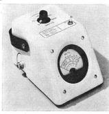
flektierten HF-Leistung, und zwar durch die einfache Betätigung eines Kippschalters. Das Gerät misst Leistungen zwischen 1 W und 500 W mit einer Genauigkeit von 5 %, und zwar im Frequenzbereich zwischen 25 und 1000 MHz. Das äusserst robuste und tragbare Gerät Typ 174A braucht weder Steckeinheiten noch Frequenzwahlen.
