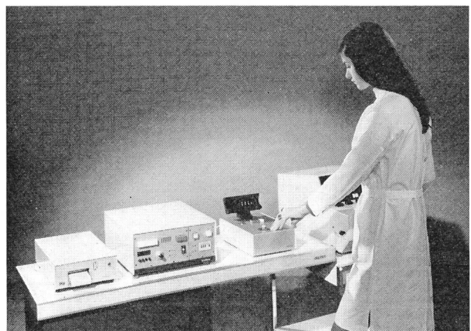
Fig. 6 Photometer-Arbeitsplatz mit Probenröhrchen-Leser, Messwert-Vorverarbeitungseinheit und Drucker
