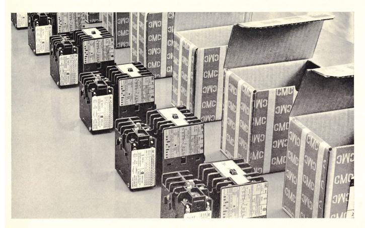
Das Schütz M4P schaltet Motornennströme bis 16 A, hat 4 Hilfskontakte (2 davon in Schliesser oder Öffner wechselbar), eine kleine Grundfläche und ist klimafest.
