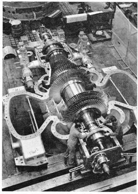
tionsbauart konstruiert. Die Figur zeigt die Turbine, die den Kompressor zu einer Gasverflüssigungsanlage antreibt, während der Werksmontage. Die maximale Kupplungsleistung beträgt 88 000 kW bei einer Drehzahl von 3420 U./min.
