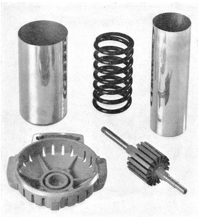
Fig. 11 Nach dem Gema-Verfahren pulverbeschichtete Objekte
