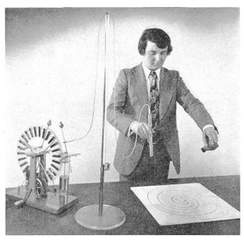
Fig. 16 Sichtbarmachen einer mit einem elektrischen Griffel gezeichneten Spirale durch Farbpartikel (Toner)
