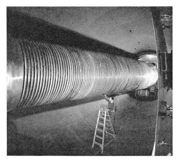
Fig. 6 Beschleunigungssäule einer 16-MV-Tandemmaschine mit SF<sub>6</sub>-Füllung von 8 bar
