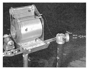
Fig. 13 Elektrostatische 15-kV-Sortieranlage
