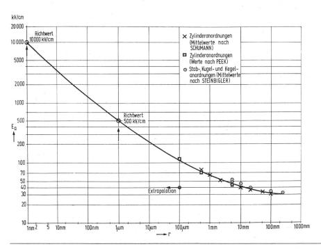
Fig. 10Anfangsfeldstärke  $E_{\rm a}$  in Abhängigkeit vom Krümmungsradius r
