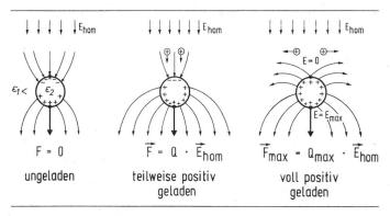
Fig. 9 Elektrisches Feld einer Kugel im Homogenfeld
