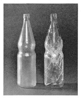
Fig. 12 Pulverbeschichtete zersplitterfreie Glasflasche
