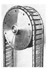
Fig. 7 Laddertron mit Antriebsrad für die 30-MV-Daresbury-Maschine [26]
