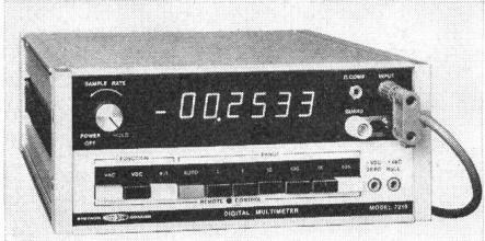
angegeben. Das Modell 7215 ist standardmäßig mit Gleichspannungs-, Wechselspannungs- und Widerstandsbereichen ausgerüstet. Der Aufbau in Schutzschirmtechnik bürgt für störungsfreie Messungen auch auf den empfindlichsten Messbereichen. Für Systemanwendungen sind die Funktionen und Bereiche programmierbar; die Isolation der BCD-Ausgänge erfolgt durch Opto-Koppler.
