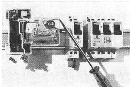
strom- bzw. Kurzschlussauslösevorrichtung versehen. Die Breite beträgt 17,5 mm beim Grundelement, womit ein kompakter Zusammenbau mit anderen DIN-genormten Installationsapparaten ermöglicht wird. Es gibt 1...4polige Ausführungen für Nennströme von 6...32 A. Bei geöffnetem Nulleiter wird ein Schliessen der Kontakte durch eine mechanische Verriegelung verhindert.
