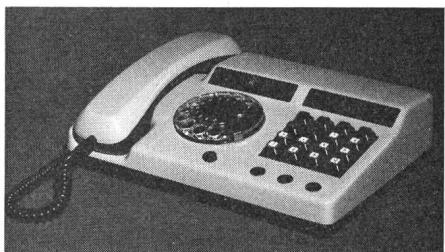
bis 4 Amtsleitungen und 5 bis 10 Sprechstellen konzipiert. Neben der üblichen Ausstattung kann sie mit Ergänzungsmerkmalen ausgerüstet werden, so zum Beispiel für Mithören und Mitsprechen bevorzugter Sprechstellen bei Amtsverbindungen oder für selbständige Amtsruftewerschaltung. (Grossenbacher Handels AG, St. Gallen)
