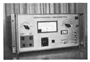
Fig. 4 Ausgeführter Oberschwingungsanalysator
