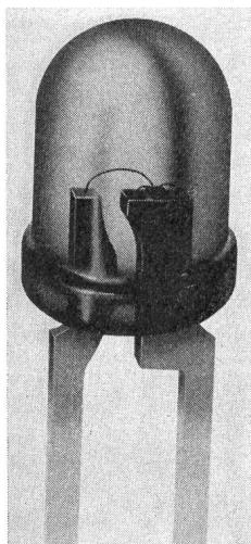
hohe Empfindlichkeit gegenüber der Schwellenspannung macht das Modell geeignet für Anwendungen, bei denen eine genaue Spannungspegelanzeige, wie beispielsweise bei Logikpegelanzeigern, benötigt wird.
