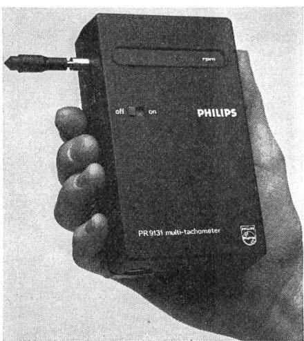
werden. Der Messwert wird digital und 4stellig angezeigt. Bei einer Messzeit von 0,6 s wird eine Genauigkeit von  $\pm 0,2\%$  erreicht.
