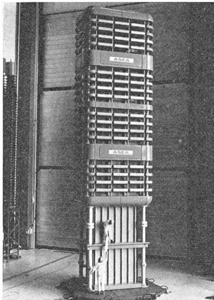
gebaut. Sechs solcher Einheiten bilden eine 12-Puls-Stromrichtergruppe mit einer Nenngleichspannung von 500 kV. Damit ergibt sich eine sechspulsige Spannung von 250 kV, was die bisher höchste Stromrichter-Nennspannung der Welt ist. (Die
