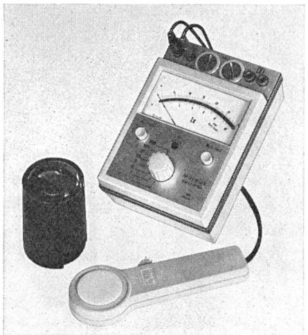
sich mit dem Messbereichschalter und der eingebauten Messbereicherweiterung einstellen lassen. Das Gerät ist in allen Messbereichen augenkorrigiert, d. h., die Spektralempfindlichkeit des Fotoelementes ist an die des Auges angeglichen. Als Stromversorgung dienen vier Quecksilber-Batterien von je 1,35 V (Typ IEC MR 9), die leicht auswechselbar sind.
