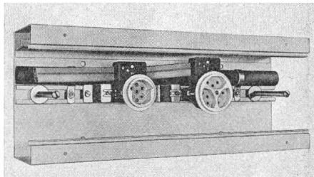
bei Brüstungen, Sockelleisten und Decken notwendig machen, ist die Amacher-Steckdose direkt anschliessbar. Ohne Abisolierarbeit ist sie innert Sekunden an einer beliebigen Stelle des formgerecht in die Kulisse eingelegten Flachkabels montierbar. Durch Eindrehen spezieller Klemmschrauben wird der Kontakt zwischen Kabel und Steckdose hergestellt, wobei der Klemmdruck auf einem metallischen Ge genlager aufgebaut ist.
