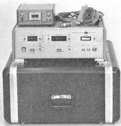
vergrössert werden. Das Messgerät besteht grundsätzlich aus einem Wobbelgenerator mit vielgestaltigen Funktionen und einem Auf- und Ab-Umsetzer. Es erlaubt viele der erwähnten Geräte zu erweitern, so z. B. erlaubt es das Messen von Verzerrungen bis in das Mikrowellengebiet, die Messungen von Gruppenlaufzeiten, Rauschen usw. an Empfängern, Sendern, Mikrowellen-Bauteilen, Baugruppen und anderes mehr.
