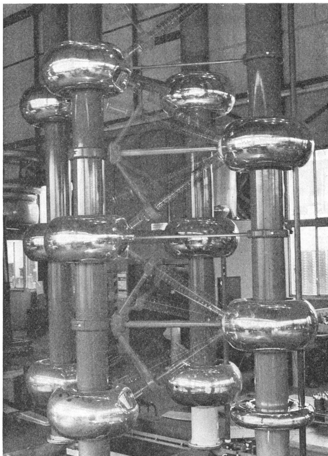
Fig. 6 Kaskadengleichrichter mit Polaritätsumschaltung
