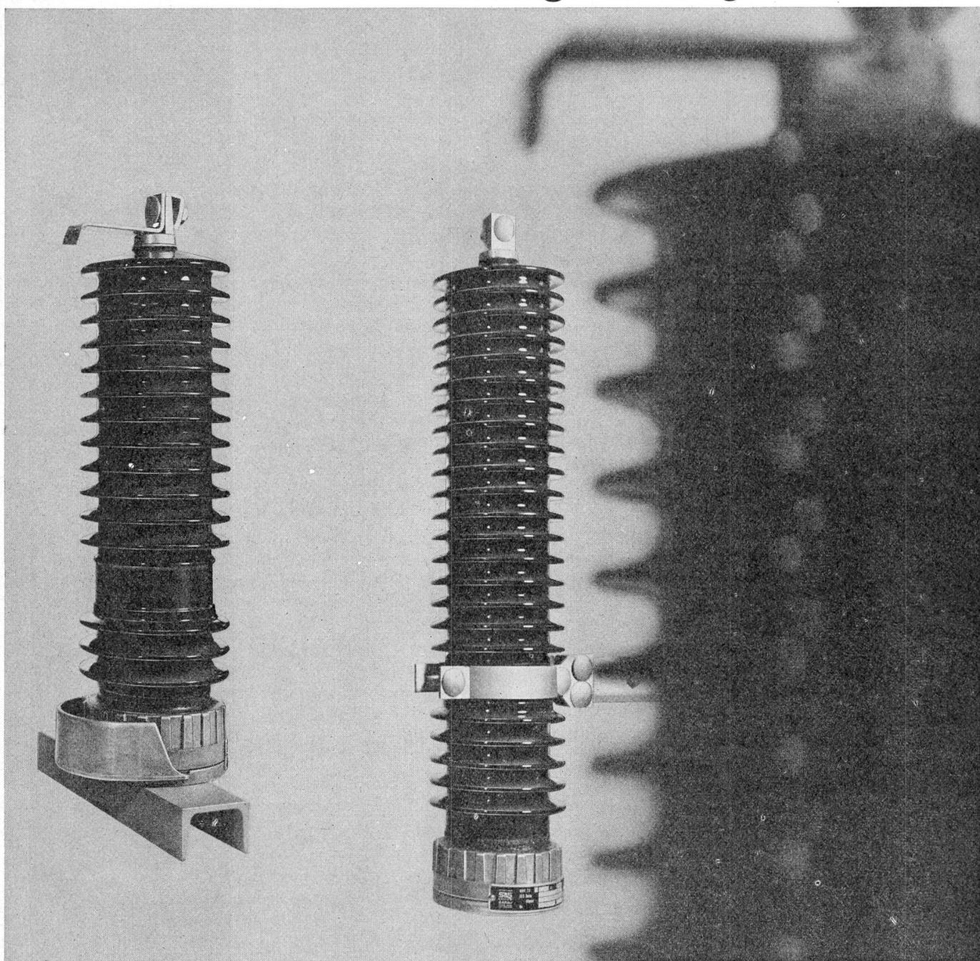
... hat Sprecher + Schuh die neuen Überspannungsableiter der Typenreihe BH7CA, Grundapparat, und BH7CC, explosionsfeste Ausführung. Nennableitstrom für beide Typen 5 kA. Mit sieben Baugrößen für 7,5 / 12 / 15 / 19,5 / 24 / 30 und 37,5 kV erreichen Sie die ideale Netzanpassung. Eine feinere Stufung in Zwischenschritten von 1,5 kV steht auf Wunsch zur Verfügung.
