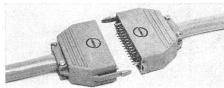
nung herzustellen. Die beiden Gehäuse werden mit Hilfe einer wechselseitigen Rastvorrichtung selbsttätig ineinander verriegelt. Durch einfachen Fingerdruck lässt sich die Verriegelung wieder lösen.
