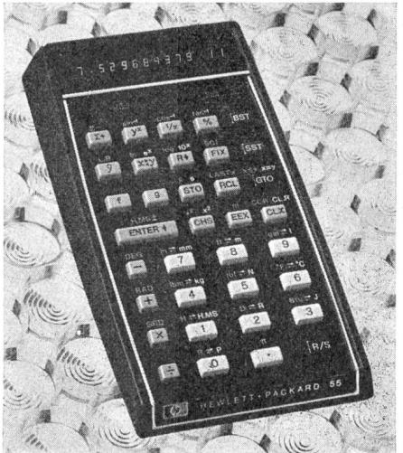
zität und einer Genauigkeit von  $\pm 0,01\%$ . Bis zu zehn Zwischenzeiten können durch Tastendruck gespeichert und weiter verarbeitet werden. Daneben sind im Rechner die üblichen fest verdrahteten Funktionen sowie Winkel- und transzendentale Funktionen vorhanden. Kennzeichnend sind ferner das Logiksystem RPN, 4 Stackregister, 20 adressierbare Speicher sowie ein Speicher für 49 Programmschritte.
