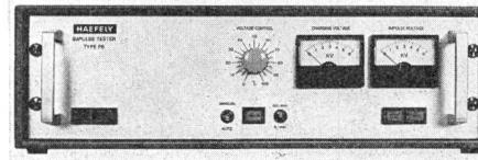
spannungsvoltmeter abgelesen. Die Betriebsweise ist wählbar: automatisch repetierend 6 oder 60/min oder Einzelauslösung. Das Prüfgerät hat zusätzliche Ausgänge für regelbare Wechselspannung bis ca. 4 kV Scheitelwert. Eine weitere Anwendung ist die Isolationskontrolle in Niederspannungsinstallationen. Dort lassen sich Schwachstellen, die von herkömm-
