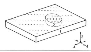
Fig. 8 Orthoferritkristall mit «Bubble»
