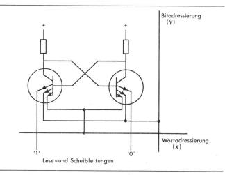
Fig. 7 Halbleiterspeicherzelle : integriertes Flip-Flop mit Mehrfachemitter-Transistoren
