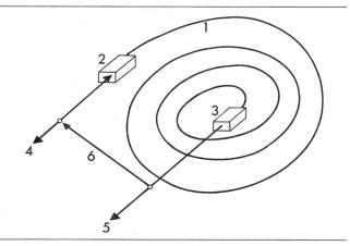
Fig. 6 Verzögerungsspeicher mit Drahtspirale
