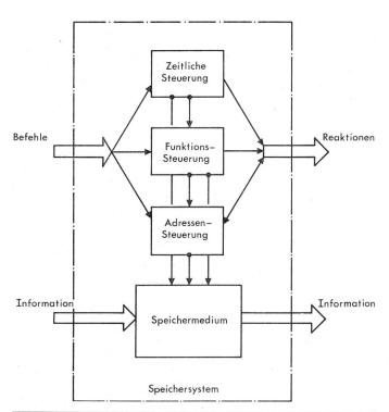
Fig. 1 Das Speichersystem und seine Subsysteme
