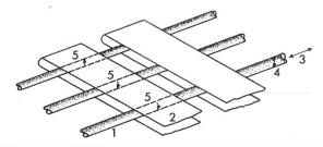
Fig. 5 Prinzip des Univac-Drahtspeichers
