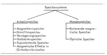
Fig. 3 Klassifizierung der Speichersysteme nach Technologien
