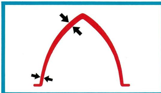
Ergibt Stabilität auch bei Überbelastung und sicheres Abweisen von Fremdkörpern durch spitzen Auftreffwinkel.
