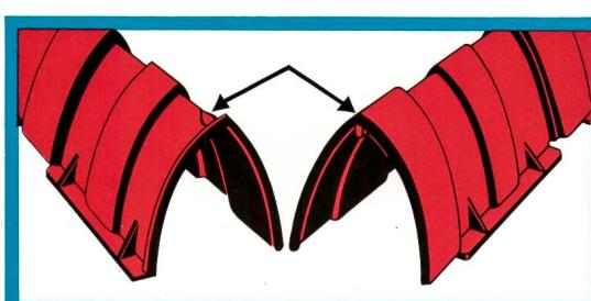
Verhindert das Wegspringen einzelner Abdeckungen beim maschinellen Einfüllen der Gräben.
