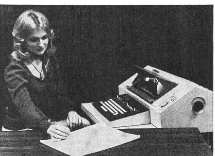
bietet die Möglichkeit, im Halb- oder Vollduplexbetrieb zu arbeiten. Der Zeichendrucker verfügt über eine Druckbreite von 132 Positionen mit dem vollen 63-Zeichensatz ASCII und mit einer Druckleistung von 10 Zeichen pro s.
