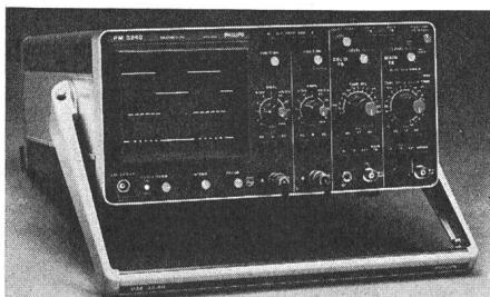
gerte und Hauptzeitablenkung, während die wichtigen Bedienungselemente in gleicher Höhe angeordnet sind. Dies erlaubt eine Bedienung des Gerätes, ohne den Blick vom Schirm wegwenden zu müssen. Durch die eindeutige Trennung der beiden Zeitablenkungen werden Verwechslungen und Fehlerquellen ausgeschaltet.
