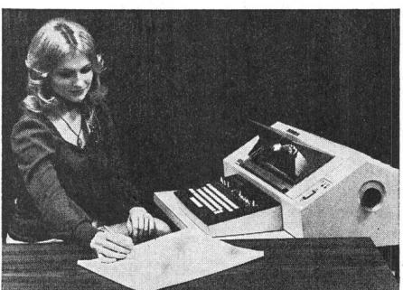
bietet die Möglichkeit, im Halb- oder Vollduplexbetrieb zu arbeiten. Der Zeichendrucker verfügt über eine Druckbreite von 132 Positionen mit dem vollen 63-Zeichensatz ASCII und mit einer Druckleistung von 10 Zeichen pro s.
