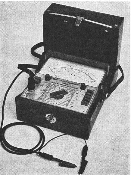
Netzbetrieb ausgelegt. Es eignet sich daher sowohl als Labor- wie auch als Feldinstrument. Die schnelle und deutliche Ablesung wird durch die 15-cm-Spiegelskala erleichtert. Die Möglichkeit, den Nullpunkt im Zentrum zu wählen, gestattet, das Multimeter als Null-Detektor oder als hochohmiges Galvanometer mit einer Empfindlichkeit von 50 µV bzw. 5 nA per Eichteil zu verwenden.
