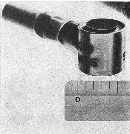
Aufnehmer hat eine Höhe von 6 mm, der andere, der einseitig angeschraubt werden kann, eine solche von 8,5 mm. Bei diesen kleinen Abmessungen wird eine Steckverbindung für das Anschlusskabel problematisch, es ist deshalb fest (und dicht) an den Aufnehmer angeschlossen. Der Messweg bei Vollast beträgt 6  $\mu\text{m}$ .
