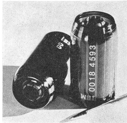
habung von Plattspeichern verbindet, kündigt die *IBM Schweiz*, Zürich, an. Das neue Massenspeichersystem 3850 ist praktisch eine automatisierte Kassettenbibliothek, die on-line arbeitet. Die Kapazität des neuen Systems erreicht  $35 \cdot 10^9$  bit in der kleinsten und  $472 \cdot 10^9$  bit in der grössten Konfiguration.
