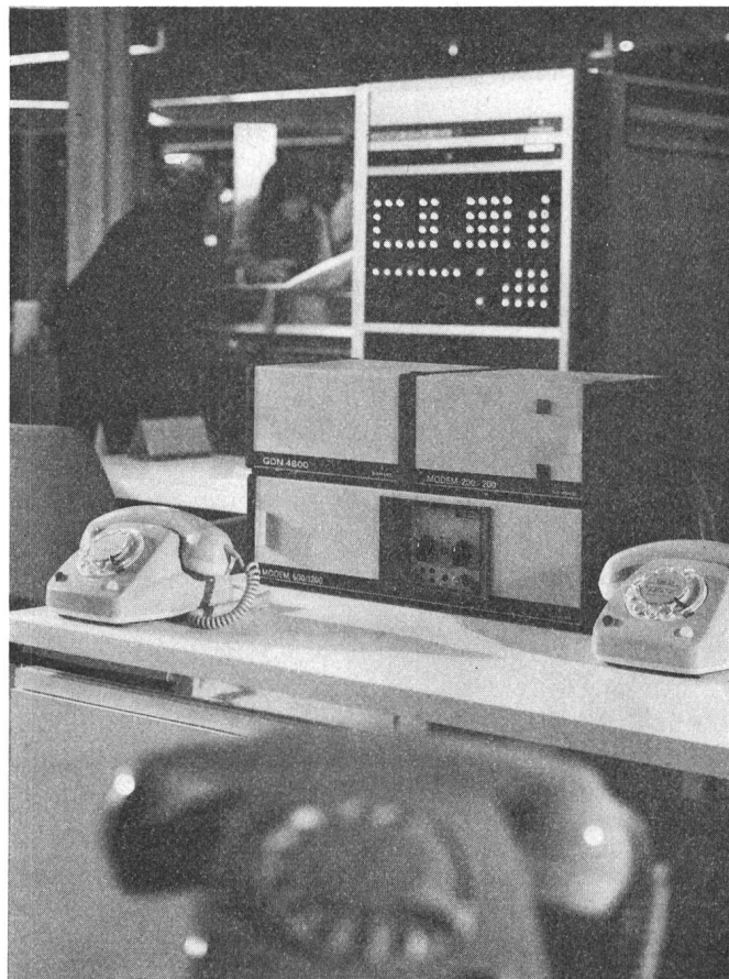
Fig. 3 Modem 200/200 (Übertragungsgeschwindigkeit 200 bit/s) und Modem 600/1200 (Übertragungsgeschwindigkeit wahlweise 600 oder 1200 bit/s)
