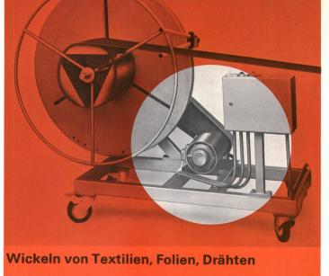
Gleichgültig, ob Sie hohe (bis 3000 m/min.), niedrige Geschwindigkeit, oder beides, oder Taktbetrieb benötigen; ob Sie breite Stoffbahnen oder dünne Drähte wickeln müssen.
