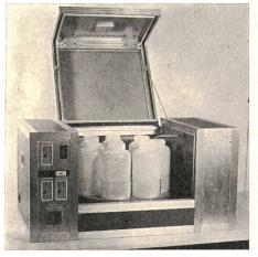
nun ein Gerät zur vollautomatischen Probenahme von Flüssigkeiten.
