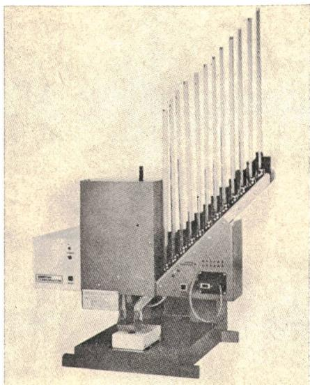
DIP-Röhren, die durch 6 Druckknöpfe, einen pro Röhre, betätigt werden. Zusätzlich kann der Sequenzer SC-100 verwendet werden, der Röhren mit 14- und 16poligen IC-Bauteilen zur Verarbeitung entweder mit dem CI-100 oder von Hand vorbereitet, wobei eine Bestückung der DIPs in der richtigen Reihenfolge auf dem Print garantiert wird. Die Anordnung und die Lage der Bauteile in den Röhren des Sequenzers SC-100 entsprechen genau der Bestückungsfolge eines bestimmten Printtyps.
