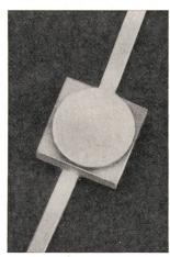
geeignet sind. Die Diode HP 5082-2200 hat ein maximales Rauschen von 6 dB und ein Stehwellenverhältnis von 1,5. Das Rauschen des preisgünstigeren Modells HP 5082-2202 liegt bei maximal 6,5 dB bei einem Stehwellenverhältnis von 2,0. Die hermetisch versiegelten Minigehäuse lassen sich in Mikrostrip- oder Stripline-Schaltungen einsetzen.
