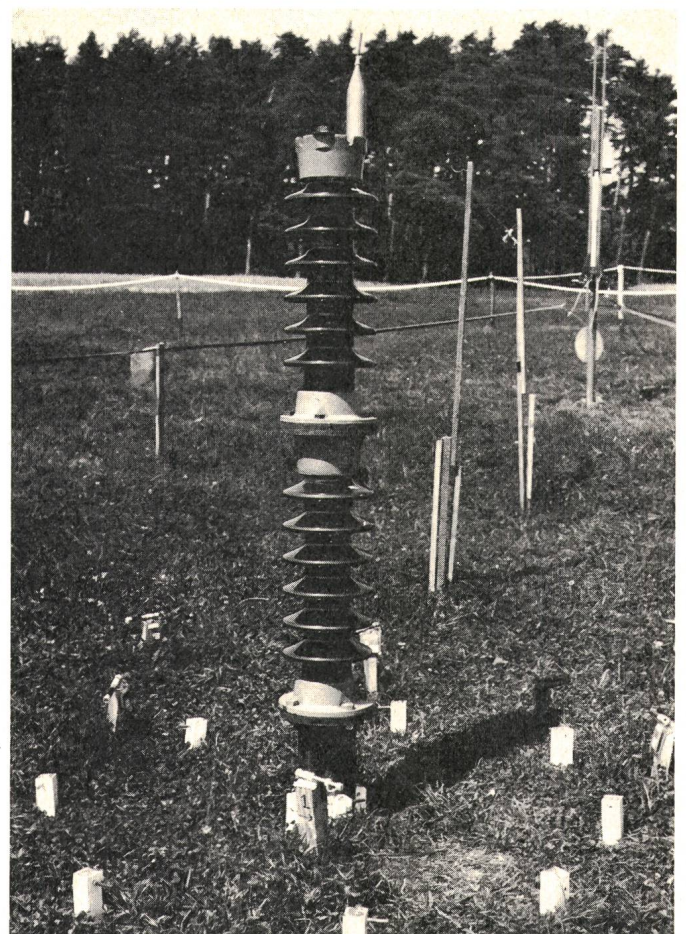
Fig. 4 Stützeranordnung des CEA mit Messproben und Triggereinrichtung
