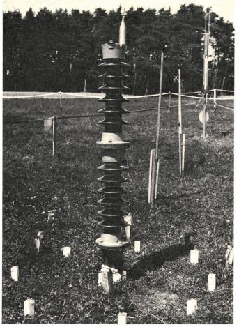
Fig. 4 Stützeranordnung des CEA mit Messproben und Triggereinrichtung
