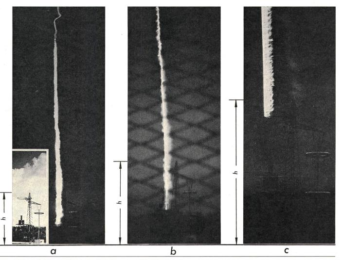
Fig. 6 Getriggerte Blitzeinschläge in den Freileitungsmast. Masthöhe h=25 mEinschlagspunkte: a Abschussrampe b Abschussrampe und Blitzfangring c Blitzfangring
