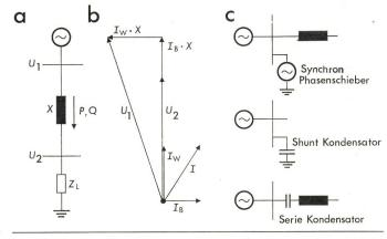
Blindleistung und Spannungshaltung (Drehstromsystem) Fig. 4
