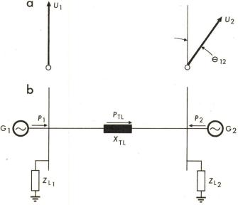
Fig. 1 Lastfluss (Drehstromsystem)
