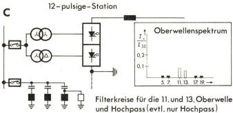
Fig. 8 Schaltungen der HGÜ-Anlagentechnik
