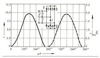
Kurzschlußstrom in einem Ventil eines HGÜ-Gleichrichters Fig. 11 bei innerem Fehler
