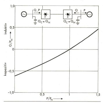
Fig. 7 Blindlastcharakteristik einer HGÜ-Station
