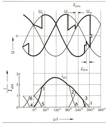
Fig. 10 Ventilüberstrom beim Leitungsfehler (optimierter Stromregler)
