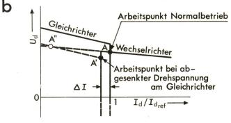
Fig. 2 Lastfluss (Gleichstromsystem)
