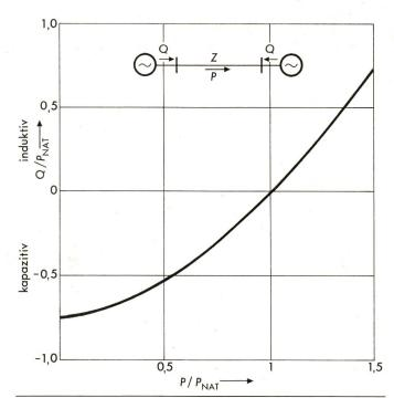
Fig. 6 Blindlastcharakteristik einer Leitung (Drehstromsystem)
