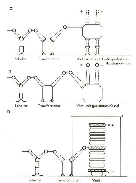
Fig. 9 Freiluft- (a) oder Innenraumausführung (b) der HGÜ-Anlagentechnik
