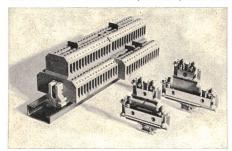
halb so breit wie normale 4-mm²-Schmalklemmen: die Effektivteilung beträgt nämlich bloss 2,6 mm. Dieser minimale Wert wird erreicht durch die seitlich versetzte Anordnung des oberen Stockwerkes.
