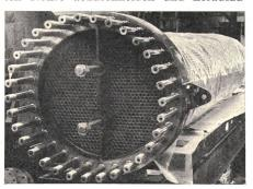
bohren, um die Art der zu verwendenden Sprengladungen zu bestimmen. Sodann werden die Rohre und Rohrwände bearbeitet, montiert und schliesslich jede Verbindungsstelle für sich durch Zünden einer kleinen Sprengladung im Inneren der Rohrenden verschweisst.
