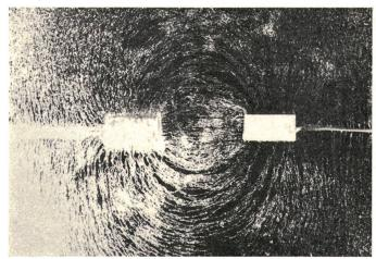
Fig. 19 Griesbild eines Luftspalts zwischen geladenen stabförmigen
