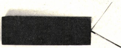
Fig. 11 Sich abstossende Magnetnadeln am Ende eines Magneten
