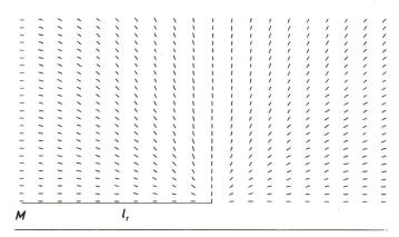
Fig. 9 Plotterbild eines Magnetquadranten unter den Voraussetzungen von Fig. 7
