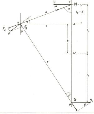
Fig. 7 Magnet mit an den Polen angenommenen Streuungen
