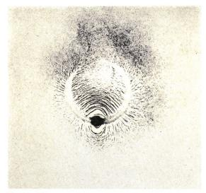
Fig. 10 Eisenpulverbild eines Ringmagneten mit Luftspalt
