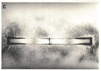
Fig. 4 Zwei Magnete gleicher Richtung in Kette
