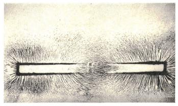
Fig. 22 Eisenpulverbild gemäss Fig. 20, nach Klopfen
