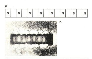
Fig. 13 Magnetverteilungsbild eines mehrpoligen Stabmagneten (a) b Eisenpulverbild des Magneten gemäss a
