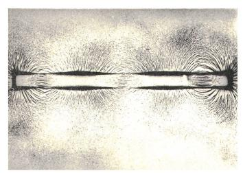
Fig. 15 Eisenpulverbild eines mit Spulen von  $^1/_8$  Magnetlänge an den Enden nachmagnetisierten Magneten
