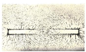
Fig. 21 Eisenspänebild eines Magneten
