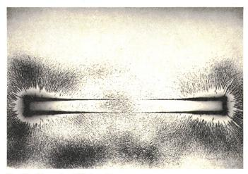
Fig. 20 Eisenpulverbild eines Magneten
