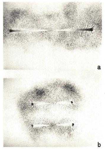
Fig. 2 Eisenpulverbild einer Stahlnadel
