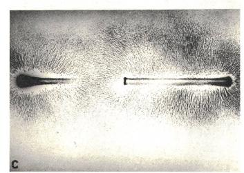
Fig. 23 Eisenpulverbild eines Magneten (a)
