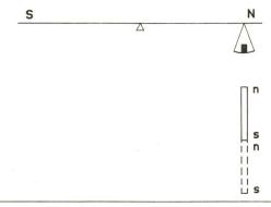
Fig. 6 Magnetische Waage
