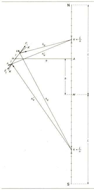
Fig. 29 Grosser Stabmagnet mit kleinem Magnet in seiner Umgebung
