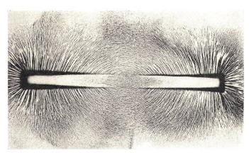
Fig. 1 Eisenpulverbild eines Magneten
