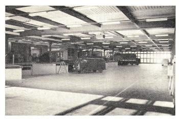
Fig. 8 Speditionshalle mit sägezahnförmiger Rampe, Anpassrampen, Hebebühnen usw.
