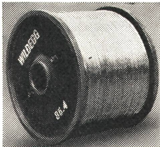
500 000 m Kupferdrähte für die Kabelherstellung
