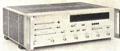
für Modems (Modulator/Demodulator), Datenkanäle und komplettete Datenübertragungssysteme durch mehrere verschiedene Messungen zur gleichen Zeit. Das Gerät ermittelt sehr schnell, ob ein Fehler im Modem, Datenkanal oder Terminal auftritt.
