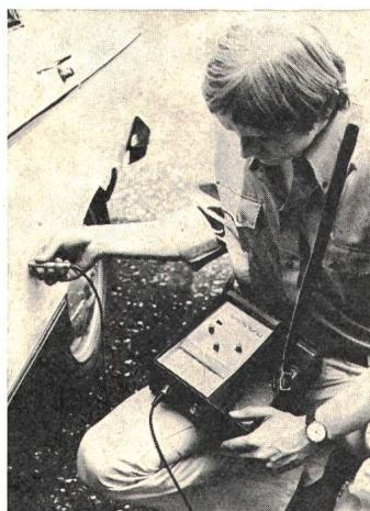
Wirbelstromverfahrens in einem einzigen Gerätegehäuse, das aus Gründen möglichst geringer Abmessungen und geringen Gewichtes für den Bereich Bauaufsicht, Abnahme und Endprüfung für den Korrosionsschutzsektor gedacht ist. Das Gerät bietet die optimalen Voraussetzungen für die Messung:
