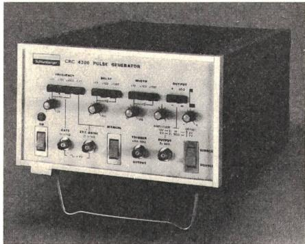
( $\pm 10$  V an  $50 \Omega$ ) verwendet werden und hat einen zusätzlichen variablen DC-Offset. Weiterhin liefert das Gerät sowohl Einzel- als auch Doppelpulse mit einstellbaren Impulsbreiten von 20 ns bis 100 ms und Verzögerungszeiten von 50 ns bis 100 ms, wobei die Anstiegs- und Abfallzeiten jeweils nur 5 ns betragen. Mit einem Umschalter an der Frontplatte sind auch einmalige Impulse möglich. Ausserdem verfügt es über einen synchronen Gate-Eingang.
