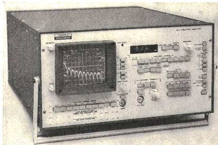
nik an Frequenzen bis 25 kHz. Für eine präzise und trotzdem schnelle Messung wird reine Digitaltechnik bevorzugt. Eine eingegebene Interface steuert einen X/Y Plotter.
