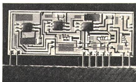
filmtechnik hergestellt. Sie sind mit Operationsverstärkern in Miniaturgehäusen hybridiert. Die jeweils gewünschten Filter parameter wie Frequenz, Güte und Verstärkung stellt man durch Lasertrimmung bestimmter Widerstände mit Toleranzen
