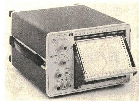
schen 10,5 und 36 V liegen. Die Genaug keit des Papiertransports beträgt 1 % bei einer Netzfrequenz zwischen 48 und 440 Hz. Die Eingangsempfindlichkeit ist 1 mV bis 100 V Vollausschlag in 16 Bereichen, mit Feineinstellungen zwischen den Bereichen.
