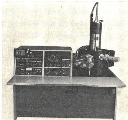
Der Vergrößerungsbereich erstreckt sich von 5× bis 120 000×. Die gezeigte Objektfläche entspricht 6 × 4,5 mm bis 1,5 × 1,1 µm.
