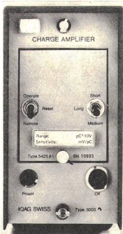
Aufnehmerempfindlichkeit, Filter usw. Die Frontplatte des Anpasseinschubes ent-hält ausschliesslich die erforderlichen Be-dienungselemente – im Extremfall gar keine.
