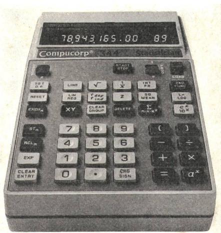
Diese Handcomputer haben bis 2 x 80 Programmschritte, 10 bzw. 12 unabhän-ge Datenregister (jedes mit 13stelliger Man-tisse und 2stelligem Exponenten mit Rück-ruf- und Austauschtaste), mehrere automa-tische Register, 2 Klammern, trigonometri- sche, logarithmische und viele problem-orientierte Funktionen.
