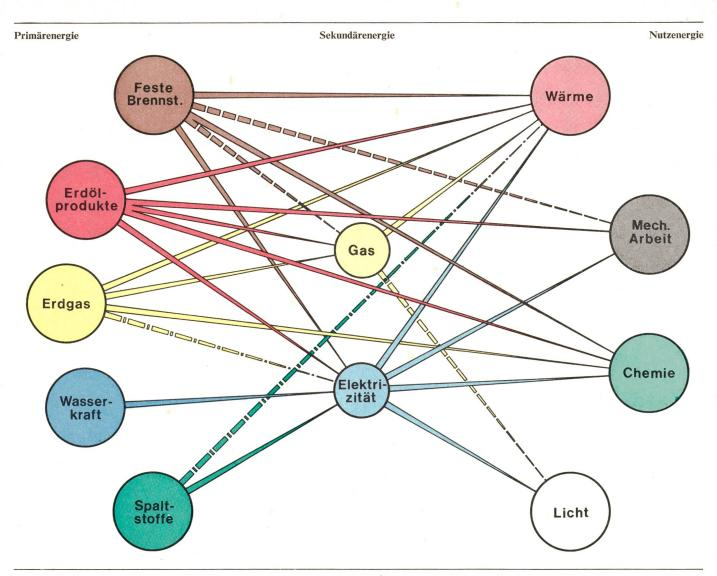
Fig. 1 Anwendungsmöglichkeiten der Primär- und Sekundär-Energieträger für die Deckung des Nutzenergiebedarfes
