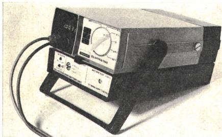
Das Instrument kann nach Angaben von Corning für die verschiedensten Lichtberechnungen an Linsen und Spiegeln verwendet werden, auch für die Kontrolle von Auto-Heckleuchten.
