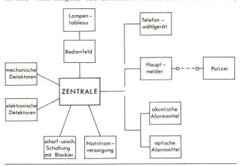
Fig. 1 Blockschaltbild einer elektrischen Sicherungsanlage
